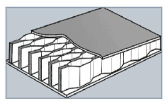
Сотовый наполнитель производится в соответствии с ТУ 5524-001-45721197-03 Размеры сотовой полосы в растянутом состоянии: 850 x 2000 мм.
